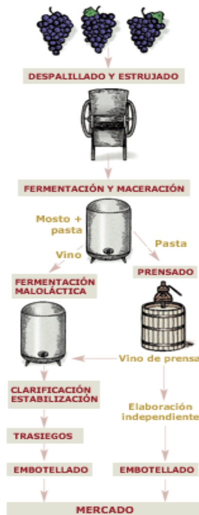
Figura 2.1 _Diagrama de flujo de la vinificación del vino joven ecológico elaborado en la bodega Viña Ijalba
